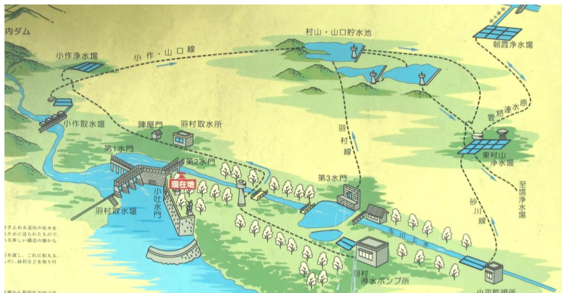
図 32 第 3 水門からの流れ(東京都水道局の羽村の説明板)
