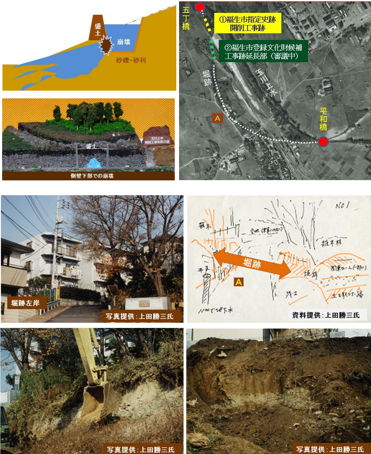
図-34 水喰土崩壊説の概念と空中写真A地点左岸の地層写真
