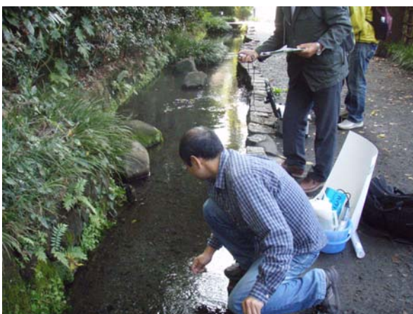
葉っぱを流して一定距離の時間から流速を測定
