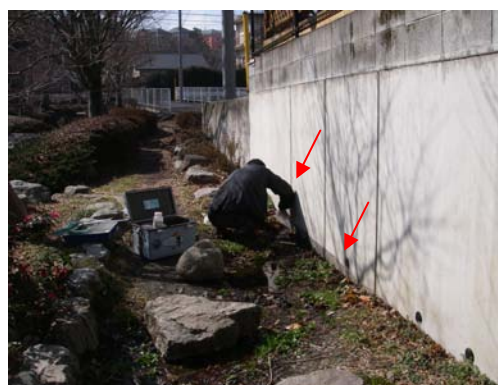
h) St. 54 草花公園 造成地の水抜き管から3種の地下水種が見つかった (2006年2月25日)
