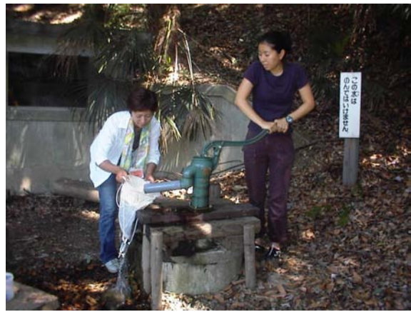
b) ひたすら水を汲み上げプランクトンネットで濾過する井戸水汲み上げ法 (2004年8月20日 St. a 聖ドミニコ学園井戸)
