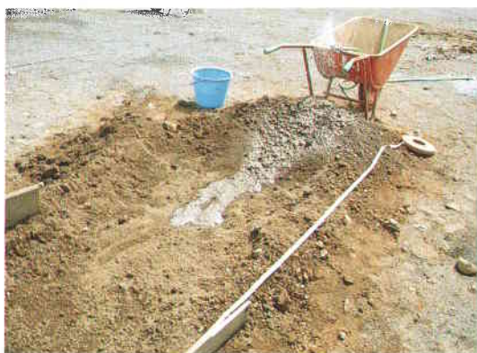
(1) 砂・赤土・礫を混ぜ、山地・平野・海を作る。山頂部より静かに散水する。
