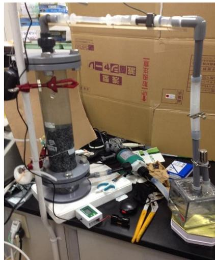
Fig.3-4-1 ④:流動床循環通水型
