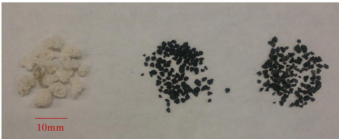
Fig.4-1 使用した濾材. 左から, CR, AC, AC (Ag) .
