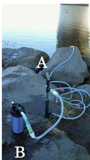
Fig. 6-3 河川水の採水. 手動ポンプ(A)と濾過装置(B)
