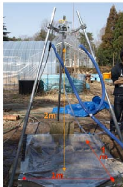
図2 散水装置とキャリブレーション結果
