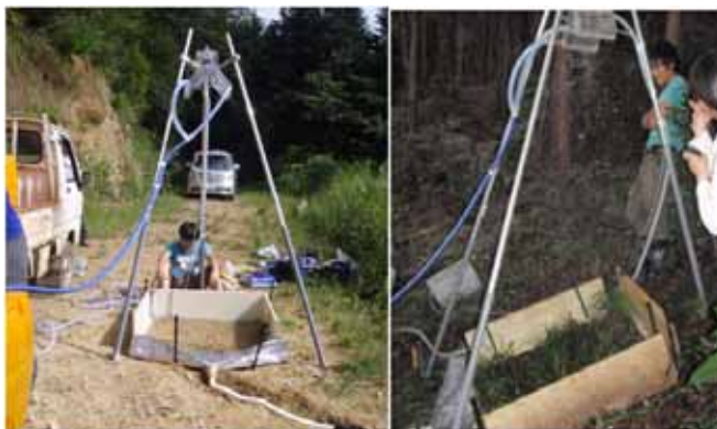
図1 現地散水実験の様子
