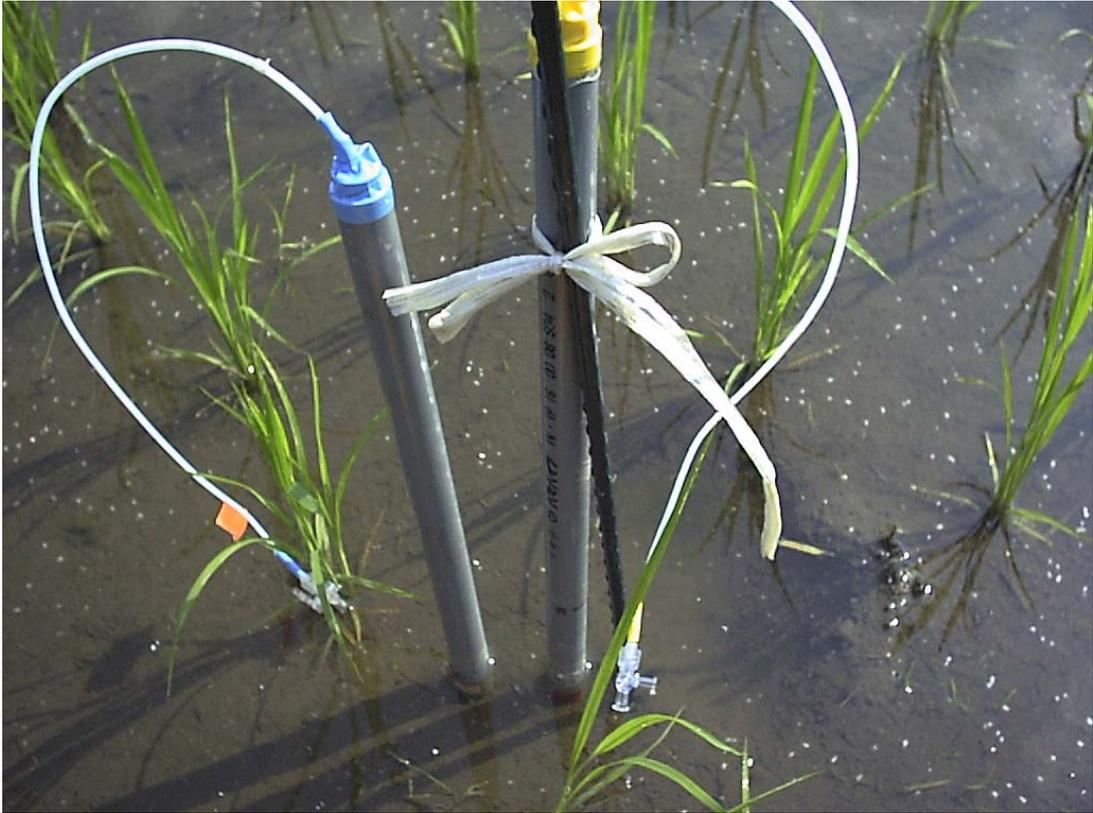
図4.6 土壤溶液採取装置の設置風景
