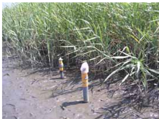
図 7-1 観測井の設置の様子 冠水を避けたためにパイプの先端を厚いビニルバッグで覆った。調査日によっては，干潟から水が引いた後も水面が干潟表面よりも上にあつたため，干潟の干満の周期とパイプ内の水位の変動の周期が同調していなかったと考えられる。
