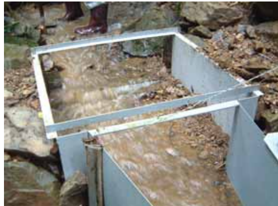
写真 9.5 同左出水時の堆砂 出水の度に大量の土砂が堆積
