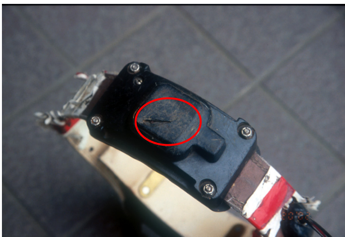
GPS アンテナ部への損傷を受けた ATS 社製 GPS 首輪
