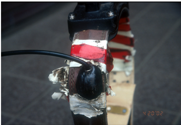
アンテナが基部より破損した ATS 社製 GPS 首輪
