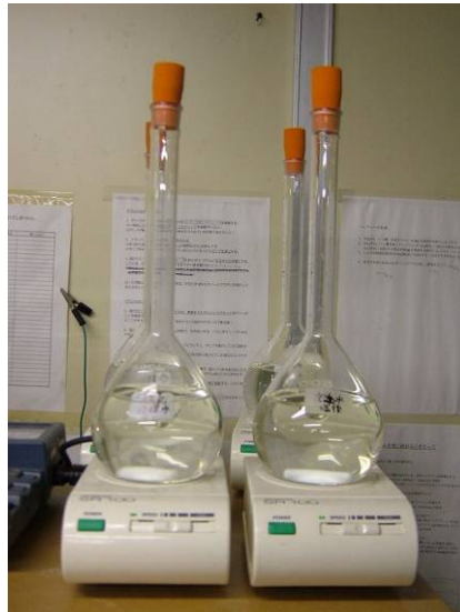
図 6.2 水質変換速度試験
