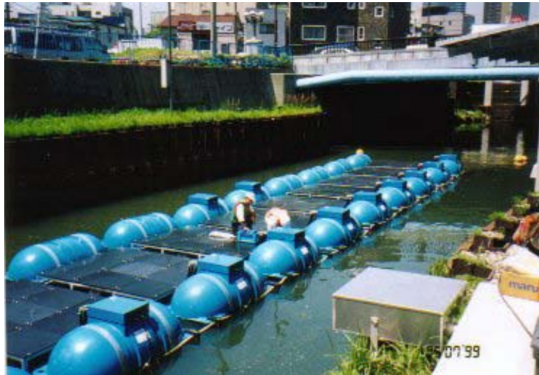
Fig.3-5 北十間川に設置された木炭浄化システム
