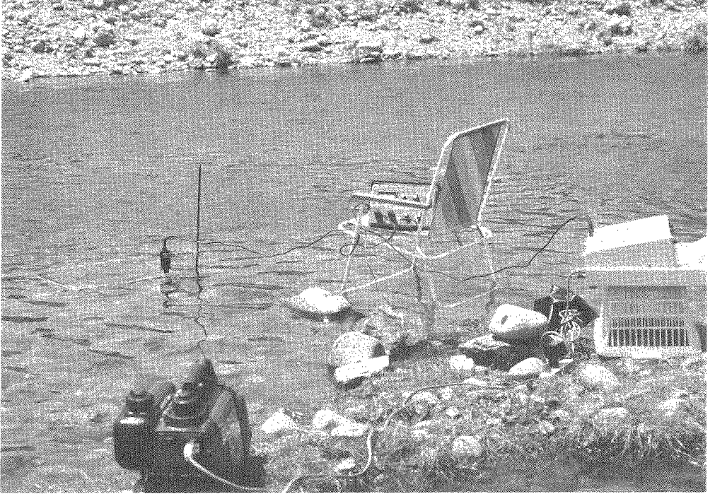
写真 2 - 1 測定装置の設置状況 溶存酸素計、レコーダー、発電器が見える
