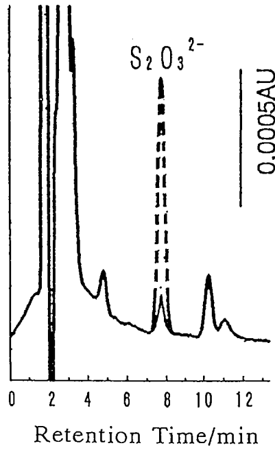
図6 間隙水のチオ硫酸イオンのクロマトグラム (点線は S_2O_3^{2-} を200ppb添加した)
