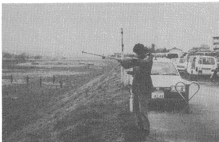
No. 26 ロケーションの様子 (土手の上から八木式3エレアンテナを左右に振って入力感度の高い方向を探る)
