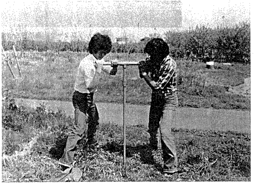
写真 2-5 ハンドオーガによるボーリング 雨間 A m-1 (中位面) にて
