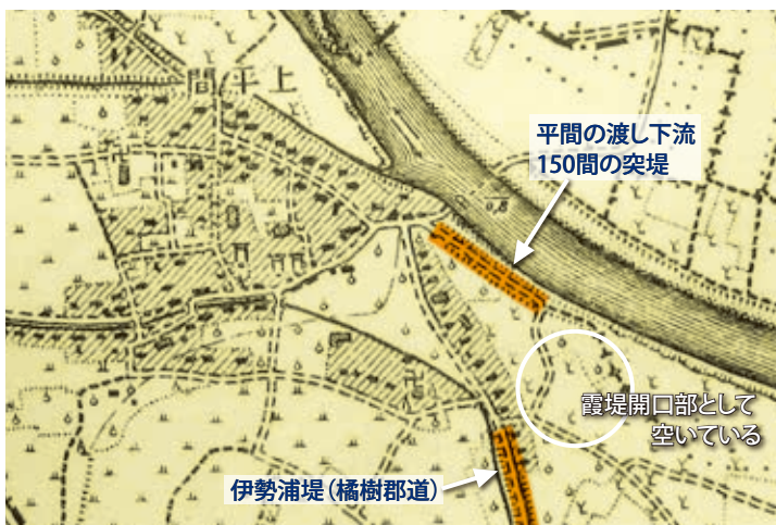
図1 霞堤構造の、平間の渡し下流150間の突堤と伊勢浦堤(明治39年測図、大日本帝国陸地測量部)
